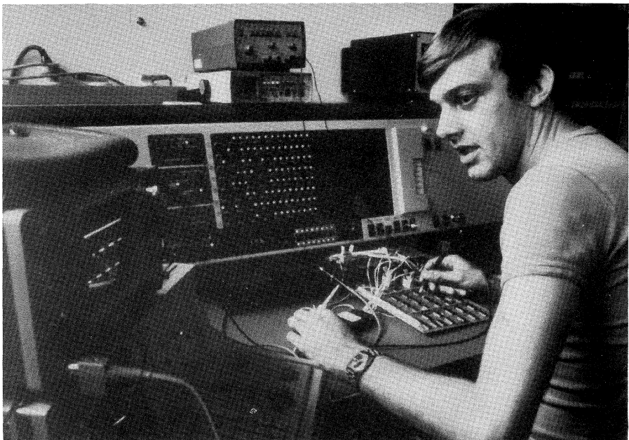
fig. 13. Testcomputer voor het testen van digitale componenten.
